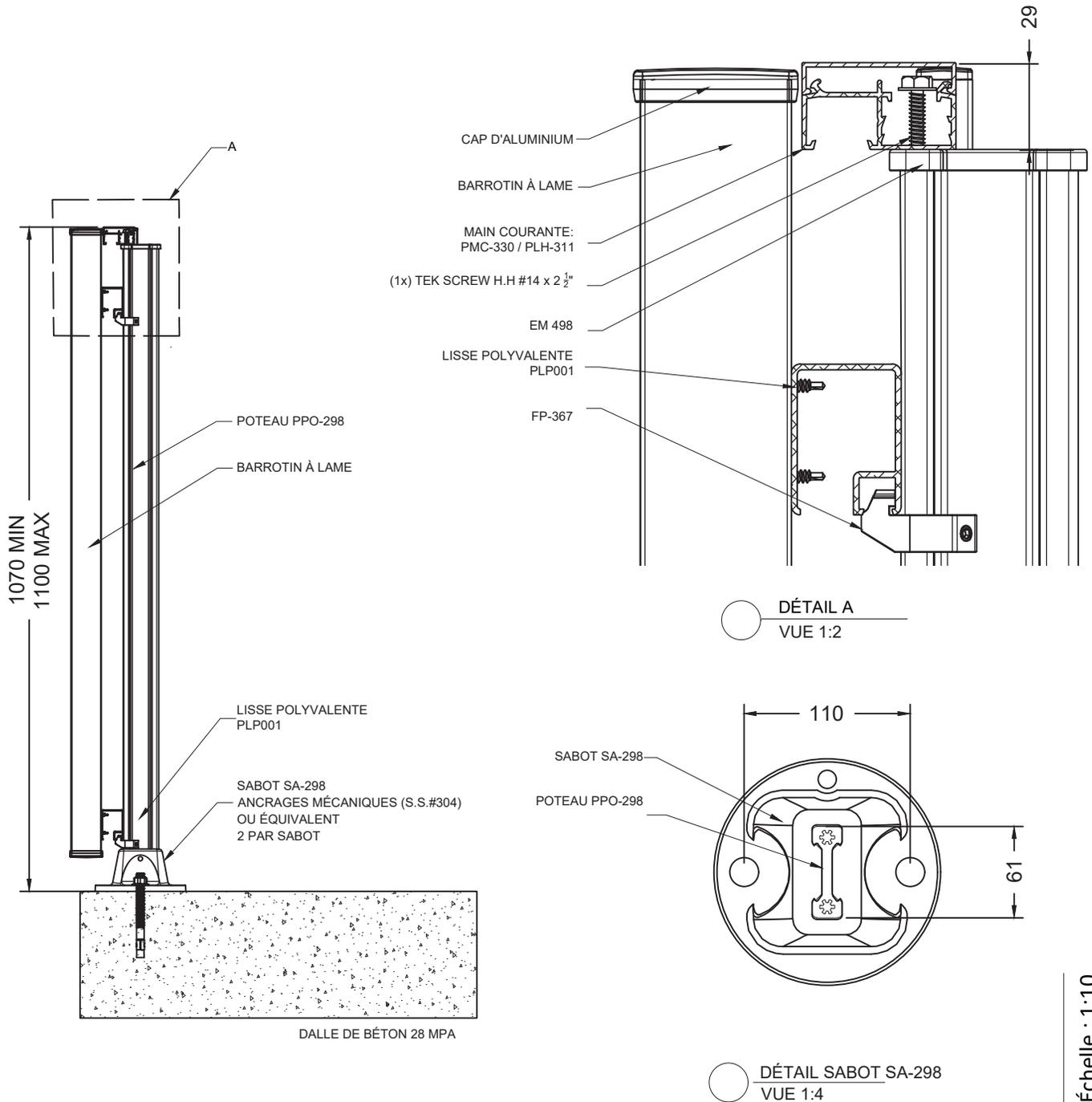
Modèle Garde-Corps **SYSTÈME À LAME SUR DALLE**
